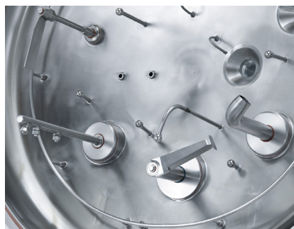
Füll-/ Waschröhr, Lockerungsschaber
