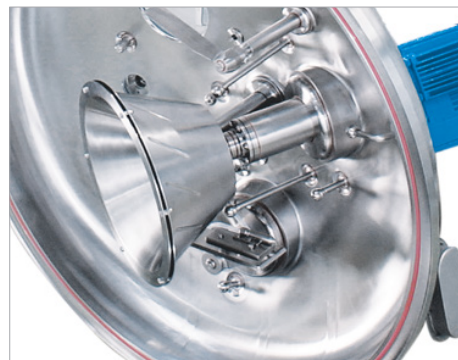
Schräger Füll-/ Waschteller, Schälmesser mit Vertikalbewegung
