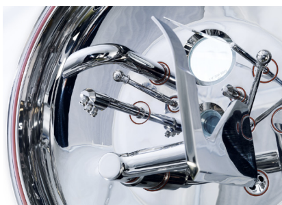
Schälmesser über die ganze Laufkorbhöhe, Füll-/ Waschröhr
