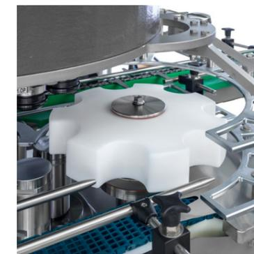
und mit grösseren Kantenradien ausgeführt. Alle Teile sind in rostfreier Ausführung. Diese lassen sich mit noch effizienteren Reinigungsmitteln reinigen. Mit den geneigten Oberflächen, dem offenen Maschinendesign, den aussenliegenden O-Ringen und abgewinkelten Oberflächen setzt Ferrum im Bereich Hygiene neue Massstäbe.
